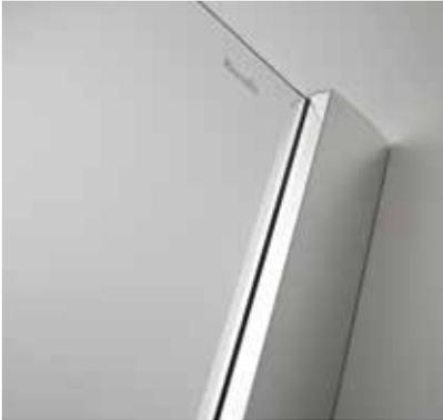
Durch den stufenlosen Verstellbereich von 15 mm im **Wandprofil** können Koralle S800 Duschabtrennungen auch bei leicht schrägen Wänden und Böden passgenau eingebaut werden. Dabei geben die Wandprofile selbst überdurchschnittlich großen Duschwänden bis zu einer Breite von 1200 mm sicheren Halt, ohne zusätzlich stabilisierende Eckkonsolen zu benötigen.
