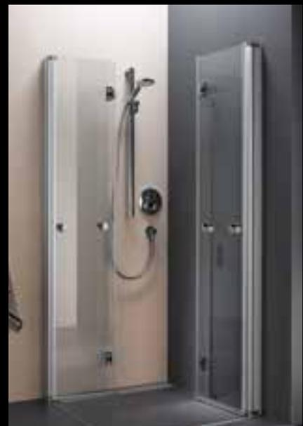
Raum zum Duschen oder grenzenlose Bewegungsfreiheit im Bad. Die myDay Duschatbrennungen mit Falttüren können vollständig und damit raumsparend an die Wand geklappt werden. Dank Hebesenkmechanismus und zwei Griffen öffnen und schließen sich die 6 mm starken Falttüren dabei leicht. Der bodengleiche Einbau ist mit oder ohne niedriger Wasserhemmleiste möglich.
