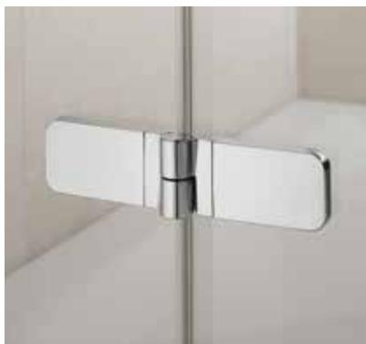
Der **Hebesenmechanismus** der Scharniere garantiert durch Anheben beim Öffnen und Absenken beim Schließen besonders leicht bewegliche Türen. Eine ideale Lösung auch bei direkter Bodenmontage. Die **Scharniere** sind so exakt mit dem Glas verbunden, dass sie innen vollkommen glasbündig abschließen und damit glatte, leicht zu reinigende Glasinnenflächen bieten.
